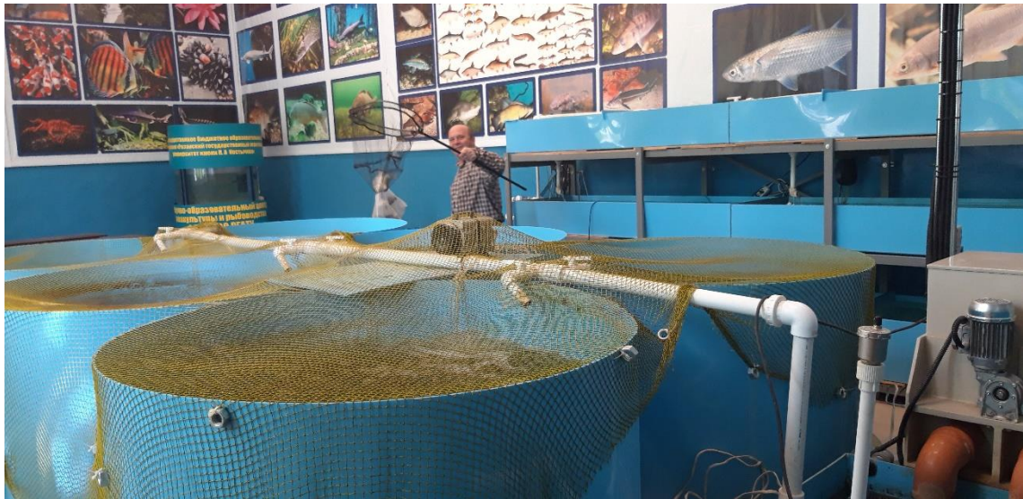
Рисунок 1 – Мини УЗВ «Рачительная», которую использовали для подращивания личинок и основная УЗВ для содержания сеголетков.
